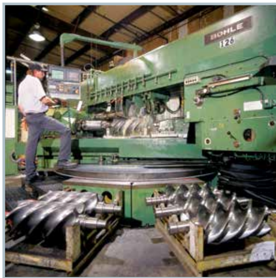
Los rotores CycloBlower se rectifican con precisión usando tecnología de fresado de última generación.
